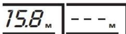
Показатель глубины в правом верхнем углу экрана появится после включения устройства и помещения датчика в воду.
